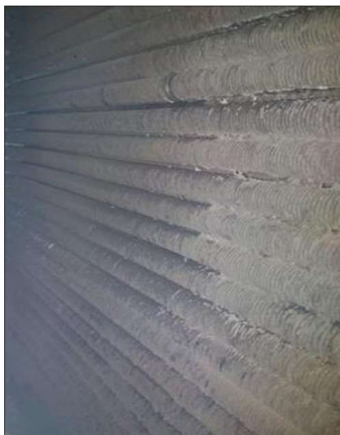
Рис. 2. Загрязнение оребренной поверхности труб в рекуперативном теплообменном аппарате в ходе его эксплуатации на промышленном предприятии
